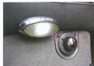
Rien ne se perd, tout se transforme chez Michelin, le propriétaire de Citroën à l'époque : ce plafonnier provient d'une Rosalie puis d'une Traction Avant ! À côté, le robinet de chauffage.
