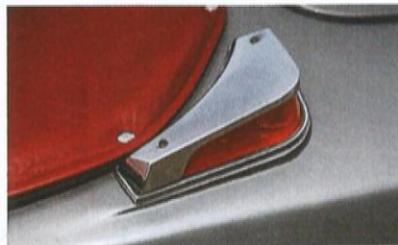
Les fameux clignotants arrière sont ici des refabrications conformes à l'origine.
